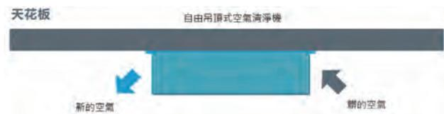
目前市場上此類產品控制方式皆為遙控控制，並且會有多段式的風量控制，唯安裝時必須要考慮室內空氣的流場，確使室內空氣能簡易的經由清淨機進入及淨化後的清淨空氣送出，嵌入式盡量在室內中央上方，自由吊頂式入口盡量不要靠近側牆(1米以上)，出口則要調整角度確使出風不被橫樑或其他障礙物擋住形成最佳流場效果。
