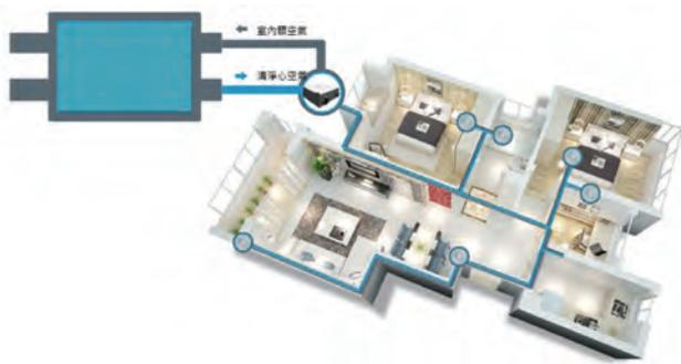
而靜電型的過濾效果在管路壓損方面就有極大的優勢，以靜電式低於過濾網 10 倍的壓損，用電量即可節省到十分之一的錢，以 150w 的機型為例一天 24 小時約為十元而已，由於商辦或住家的全熱交換機，通常容易設計一台主機搭配多個房間的應用(4-6 間)，所以在設計上就要考慮換氣時間，因為交換機使用時間較長，所以通常設計採用每小時換氣一次之換氣量，而管路設計有兩種，一為將新風送進房間後造成正壓，再將回風管送至房間內，其各送、回風口要在室內形成較佳的流場，通常是送風在空間最內側回風則靠近門口，此項設計的缺點為天花板內管路眾多，空間高程不易取得，穿樑多、維護也較麻煩，另一種設計為送風同樣是送至房間最裡側造成正壓後回風僅在較大空間(大廳、走道或廚房)內，如此可形成較少的管路交叉，安裝位置依順序考慮為廚房、陽台、儲藏室、地下室、閣樓、廁所、走廊，盡量不影響到管路及天花板內其他設備的安放位置及產生過大噪音，全熱交換機使用在小空間內時由於靜電板會產生臭氧來殺菌，所以靜電式集塵機會配有消除臭氧的複合式過濾金屬板，以避免臭氧過多產生的不舒適現象。
