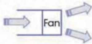
圖 4 Type C 風管入口、自由出口
