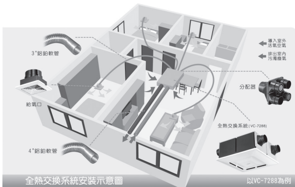
【圖一】全熱交換系統安裝示意圖
